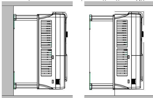
Рис. 4-2 Способ установки
