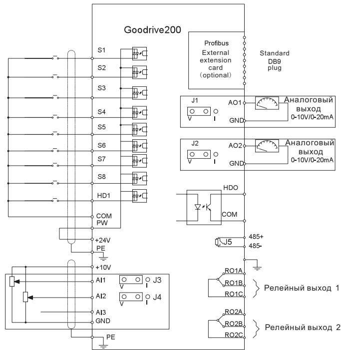
Рис. 4-19 Схема подключения цепей управления и контроля
