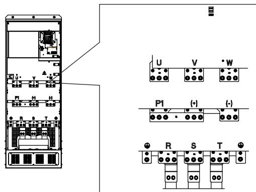
Рис.4-17 350~500 кВт клеммы силовых цепей
