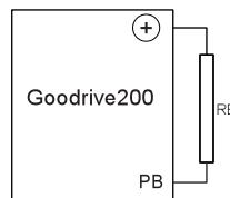
Установка тормозных модулей:
