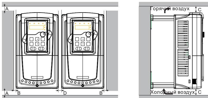
Рис. 4-4 Параллельная установка
