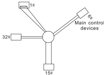
Рис. 10.5 Подключение «Звезда»
