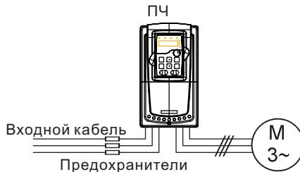
Рис. 4-24 Подключение предохранителей
