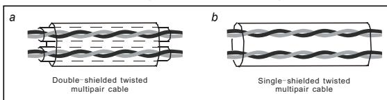
Экранированный кабель является лучшей альтернативой для цифровых сигналов низкого напряжения, (рисунок В). Однако для ввода задания частоты, всегда используйте экранированный кабель..
