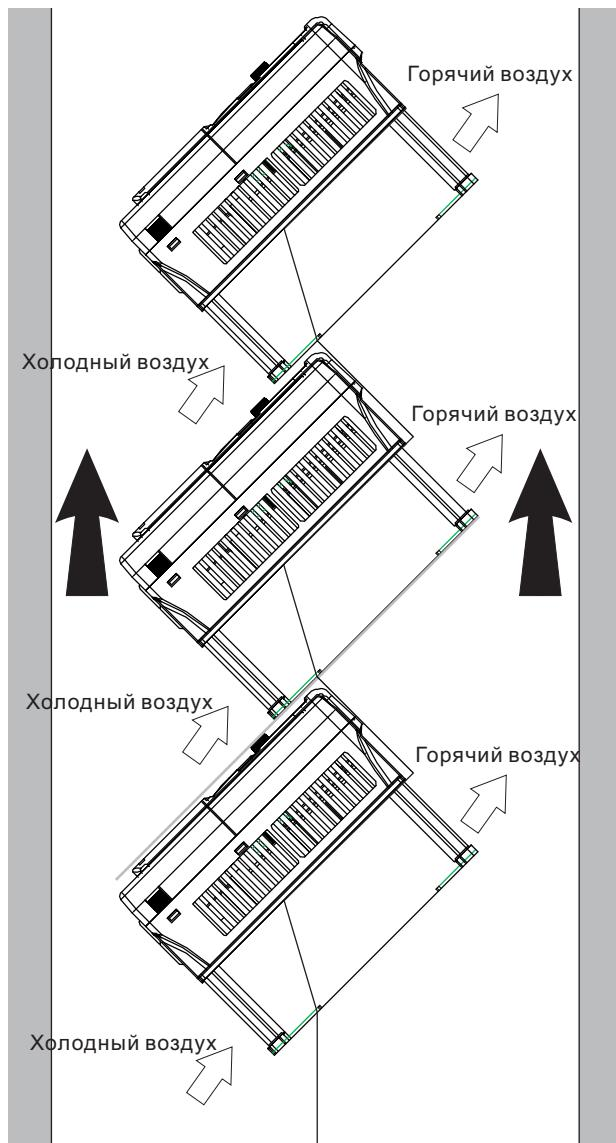
Рис. 4-6 Наклонная установка
