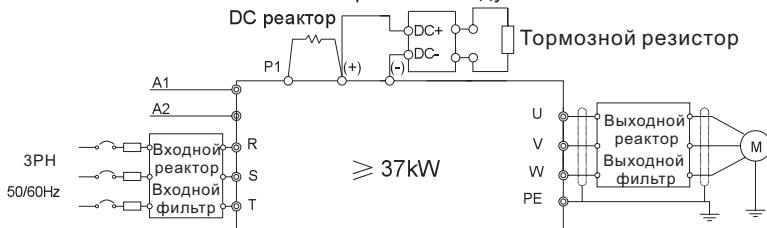
Рис. 4-7 Схема подключения силовых цепей
