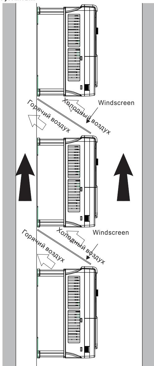
Рис. 4-5 Вертикальная установка
