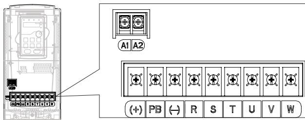
Рис. 4-10 7.5~11 кВтклеммы силовых цепей
