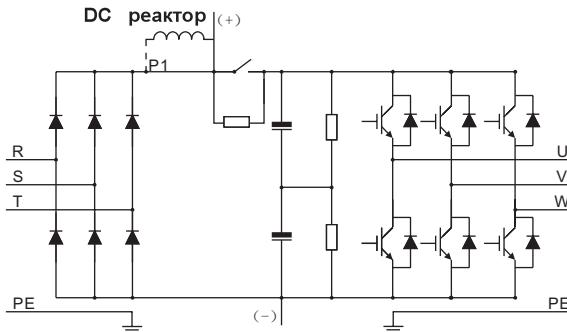
Рис. 3-1 Схема силовой цепи(≤30кВт)
