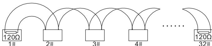
Рис. 10.2 Подключение «Шина»
