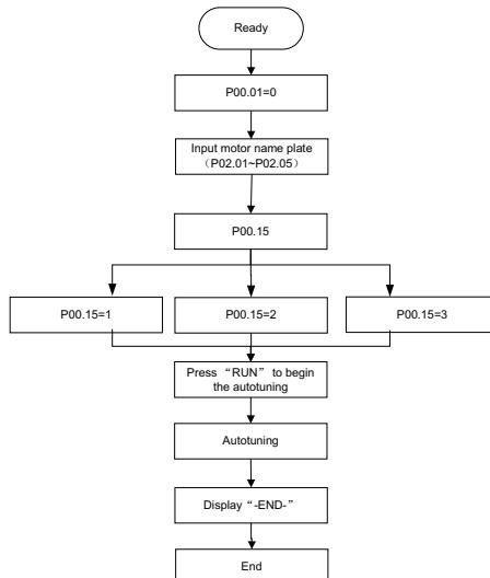
Контроль производительности ПЧ основан на установленных точных моделях двигателя. Пользователь должен выполнять автонастройку двигателя перед первым запуском (брать Двигатель 1 в качестве примера).
