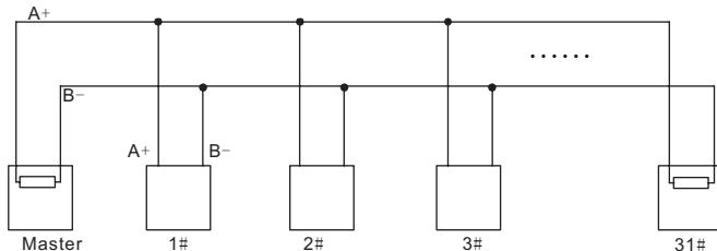
Рис. 10.3 Подключение «Шина»
