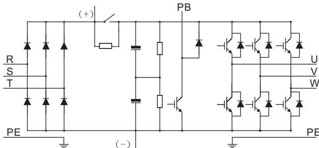
Рис. 3-2 Схема силовой цепи(≥37кВт)
