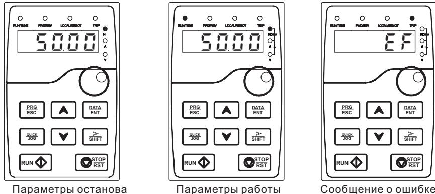
Рис. 5-2 Состояние дисплея
